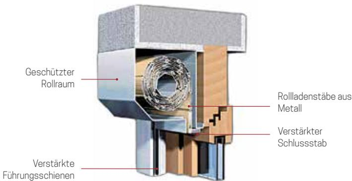
↗ Querschnitt eines Rollladens nach DIN EN 1627
